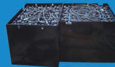
蓄电池组件 battery pack
