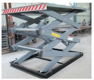
SJG固定式液压升降平台是用于建筑物层间运送货物的专用液压升降台,产品主要用于车间、仓库和各种工作搁层货物上下运送:立体车库和地下车库层高间汽车举升等。产品液压系统设置防坠、超载安全保护装置,各楼层和升降台工作台面均可设置操作按钮实现多点控制。产品结构坚固,承载量大,升降平稳,安装维护简单方便,是经济实用的低楼层间替代电梯的理想货物输送设备。
