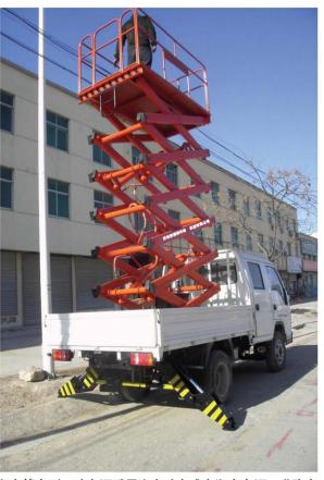
该系列产品可根据客户需求选用解放、东风江铃、福田、电瓶车等车型。动力源采用汽车动力或电瓶车电源。升降车移动速度快、作业范围大、升降无需外接电源、机动性强。广泛应用于市政建设维护、路灯照明、公路设施维护、工程抢修、园林设计剪修等高空作业行业。
