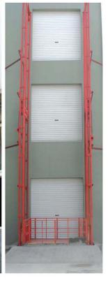
导轨式升降货梯主要用各种工作层间货物上下运送,立体车库和地下车库二、三层高楼间、无法开挖地坑场所。顶层高度不能到达要求的场合等比较解决的狭小空间,我们将竭尽全力为你量身打造高效率的送货平台,产品液压系统设置防坠、上下层门互动连锁,各楼层和升降台工作台面均可设置操作按钮,实现多点控制、产品结构坚固,承载量大,升降平稳、安装维护简单方便,是经济实用的低楼层间替代电梯的理想货物输送设备、根据升降台的安装环境和使用要求,选择不同的可选配置,可取得更好的使用效果,本产品主要应用于化工、高温、高压、电厂、核工业基地、炸药等防爆企业。最大承载10吨,实现多点控制,上下楼层互动联锁、达到安全使用。
