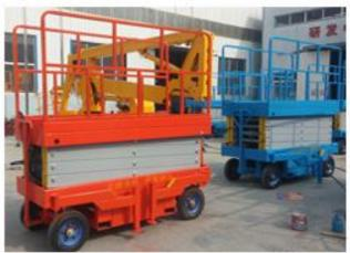
该系列产品升降高度从 4 米到 18 米,荷载重量从 300 至 1000 公斤,升降方式可为手动式、电动式、电瓶式、 柴油式等,特殊场所也可选用防爆电器,还可以根据用户需要加装遥控装置平台,移动方便,台面大,承载能力强, 可多人同时作业,安全可靠,是高空升降作业的最佳产品。
